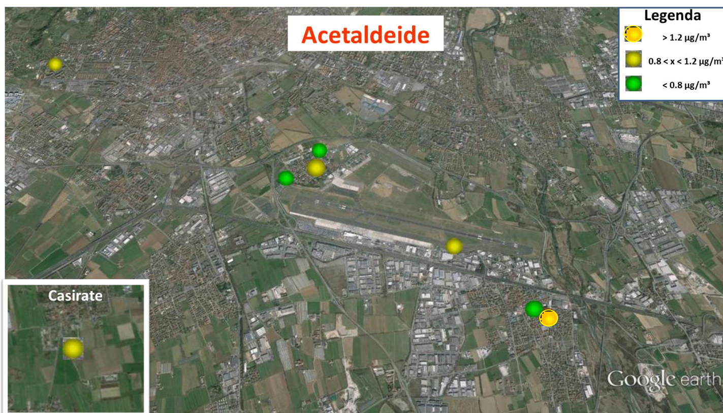
Figura 152. Visualizzazione spaziale delle concentrazioni di acetaldeide rilevate con i campionatori passivi.
