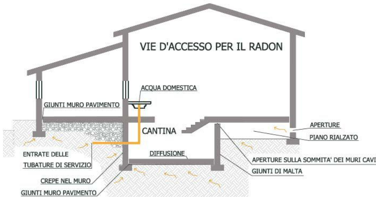
Figura 5: vie d'accesso per il radon
