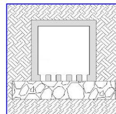
Pozzetto (in calcestruzzo, plastica, polietilene, ecc.) di dimensioni circa 50 x 50 x 50 centimetri e comunque idoneo ad alloggiare il ventilatore di progetto.
