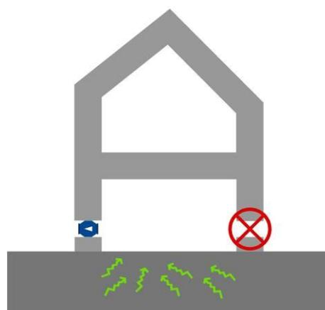
Figura 35: in caso di ventilazione forzata tramite ventilatore dovrà essere presente la sola bocca di aspirazione e chiuse tutte le altre bucares al perimetro in modo che l'impianto agisca nei confronti del terreno e non sull'ingresso dell'aria dalla bucares contrapposta.
