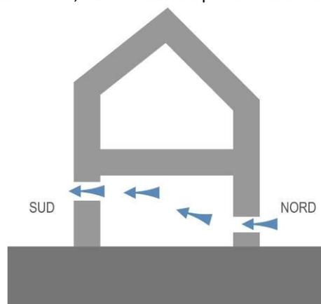
Figura 34: in caso di ventilazione naturale dovranno essere presenti bucares su due lati contrapposti dell'edificio, possibilmente nord-sud.
