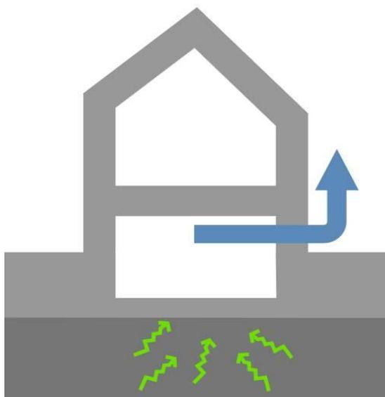
Figura 11: depressione di un volume tecnico sotto l'edificio
