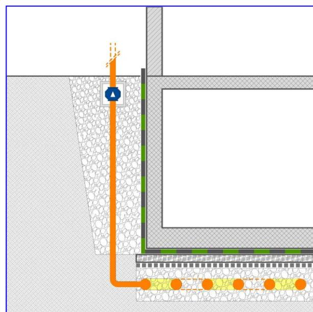
Una volta conclusa la costruzione verranno eseguite delle misure sul livello di radon presente ed eventualmente verrà alloggiato e messo in funzione un ventilatore come nel caso precedente.
