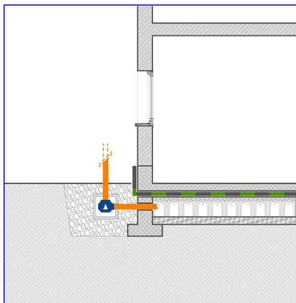
Se questa tipologia di vespaio sottostà a un volume interrato potrà essere predisposto un sistema ventilante in fase di costruzione.
