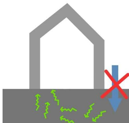
Figura 18: non pressurizzare il terreno al perimetro dell'edificio
