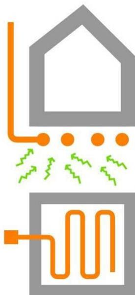
Figura 14: depressione del sottosuolo tramite tubazioni drenanti
